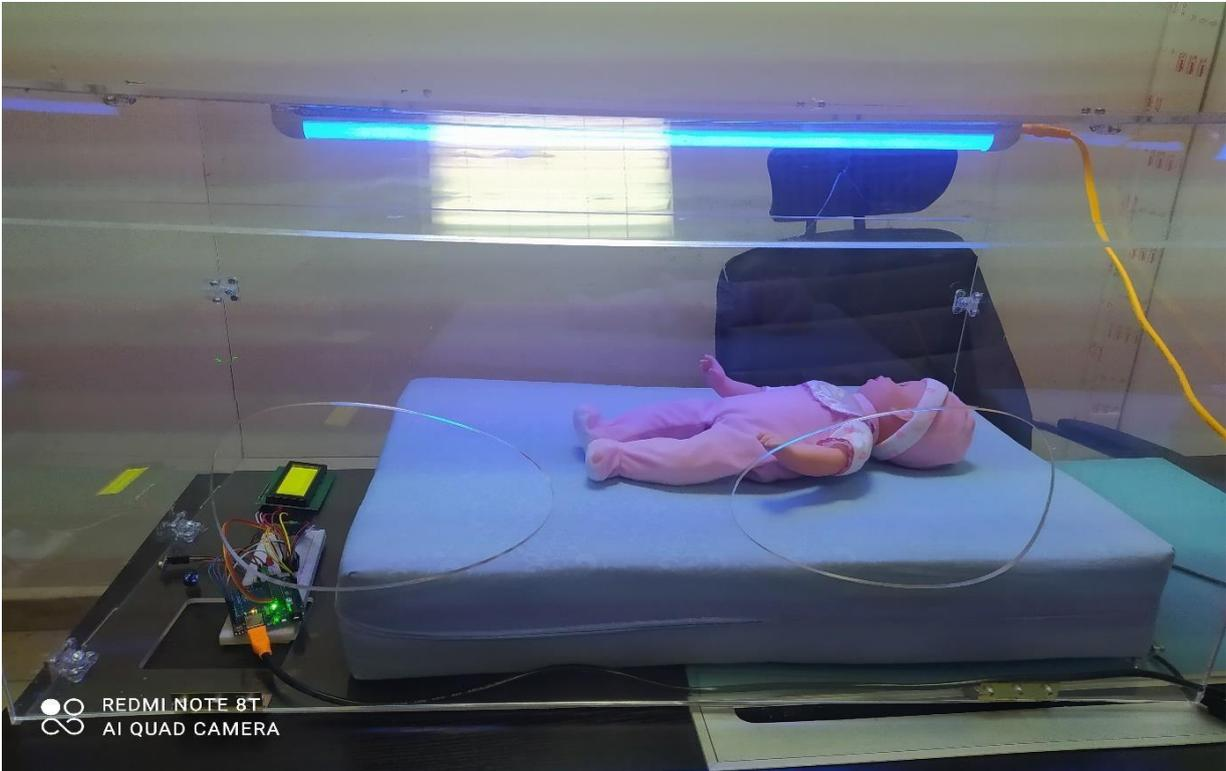
Figure III.25 : Vue réelle du prototype de la couveuse intelligente.
