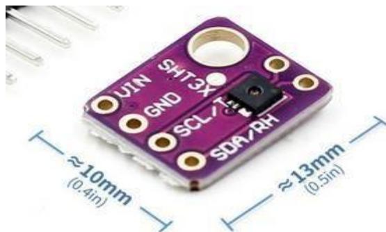
**Figure II.5 :** Capteur d'humidité et de température SHT3X.
