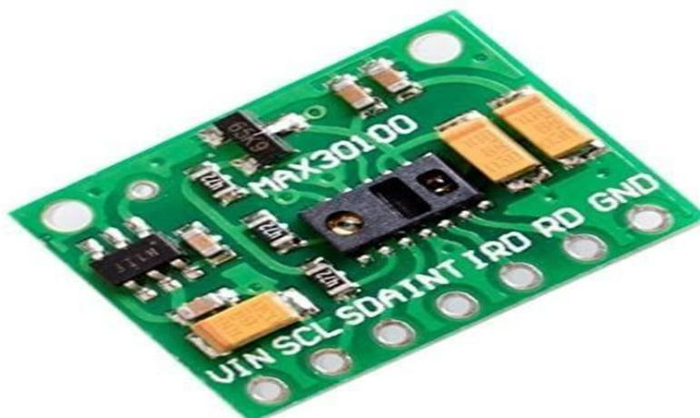
**Figure II.7 :** Le capteur de fréquence cardiaque et taux d'oxygène MAX30100.
