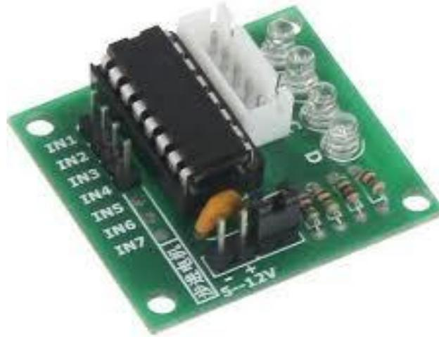
**Figure III.8:** Driver moteur STP01 (UNL2003)
