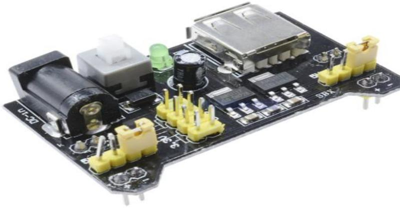
**Figure III.11 :** *Alimentation pour Arduino MB102*
