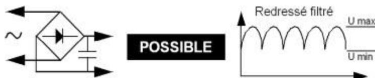
Figure IV.7. Connexion à une alimentation CC stabilisée, redressée et filtrée
