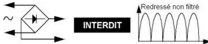
Figure IV.8. Raccordement redressé non filtré
