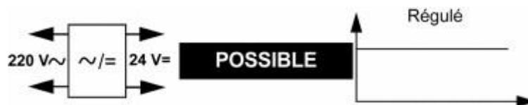
Figure IV.6. Connexion à une alimentation CC stabilisée
