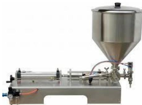
**Figure II.4 remplisseuse semi-automatique**
