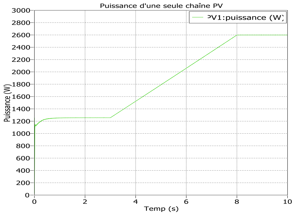
Figure III 6: puissance d'une seule chaîne photovoltaïque.
