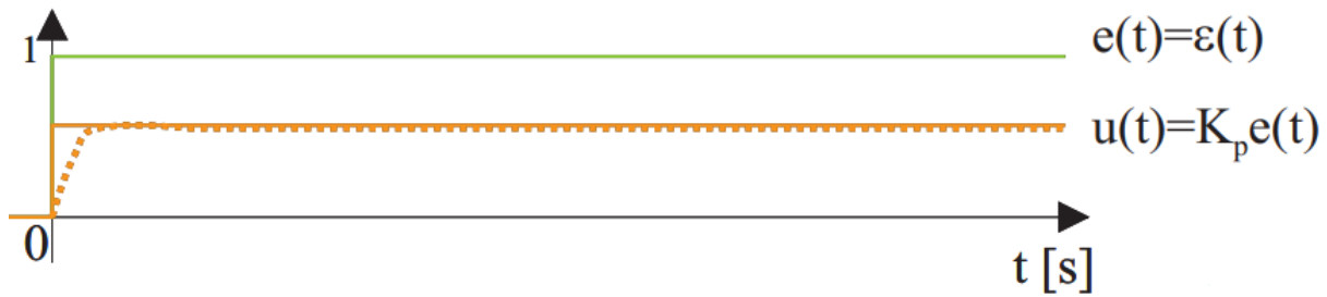
Figure 2.6 : Réponse indicielle du régulateur
