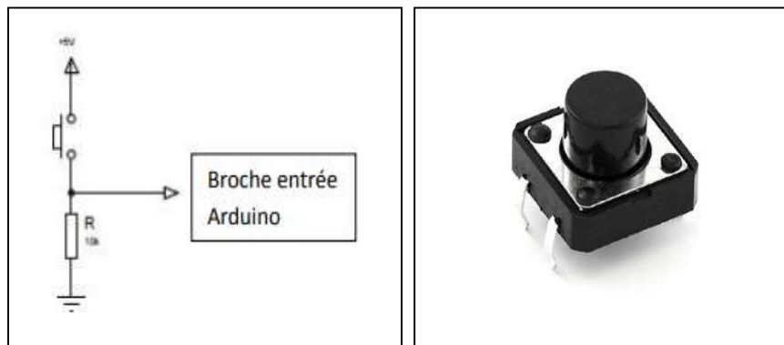
Figure III.35 : Bouton poussoir (Droite : schéma avec câblage, Gauche : Pièce Original)
