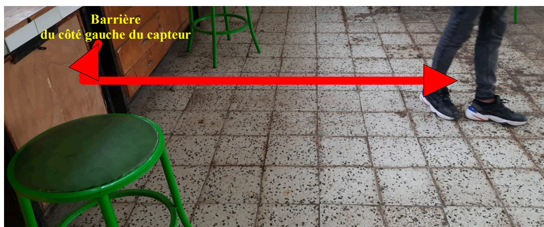
Fig.4. Quatrième Test : Pour limiter le champ de vision du côté gauche (Angle de vision)
