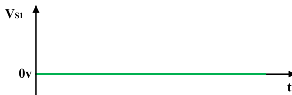
Fig.13. Forme du signal obtenue (Contacts A et B sont reliés : pas de détection)
