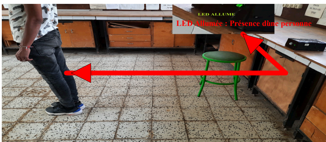
Fig.1. Premier Test : Capteur à 1m
