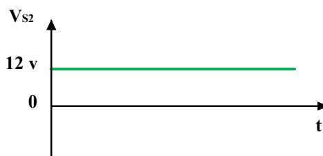
Fig.19. Signal de sortie sur la broche 3 de la porte NAND (Absence d'une personne)
