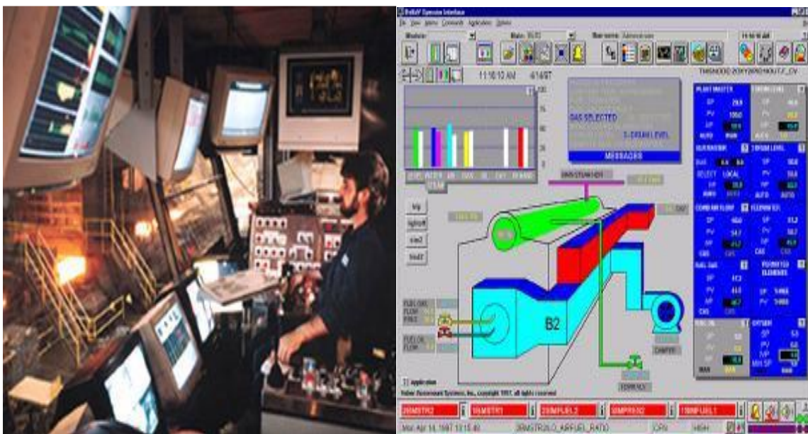
Figure 1.2 : (a) poste de supervision (b) exemple d'Interface Homme-Machine
