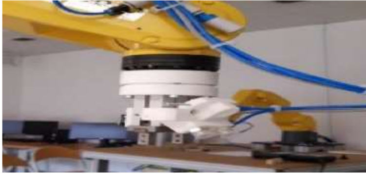
Figure 3-2 : Pince + ventouse montées sur un robot Fanuc
