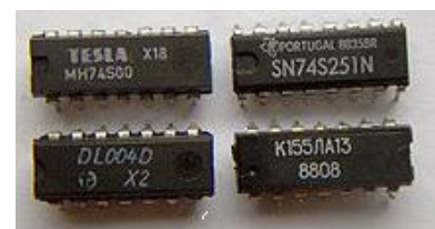
Fig.2. Circuit intégré TTL
