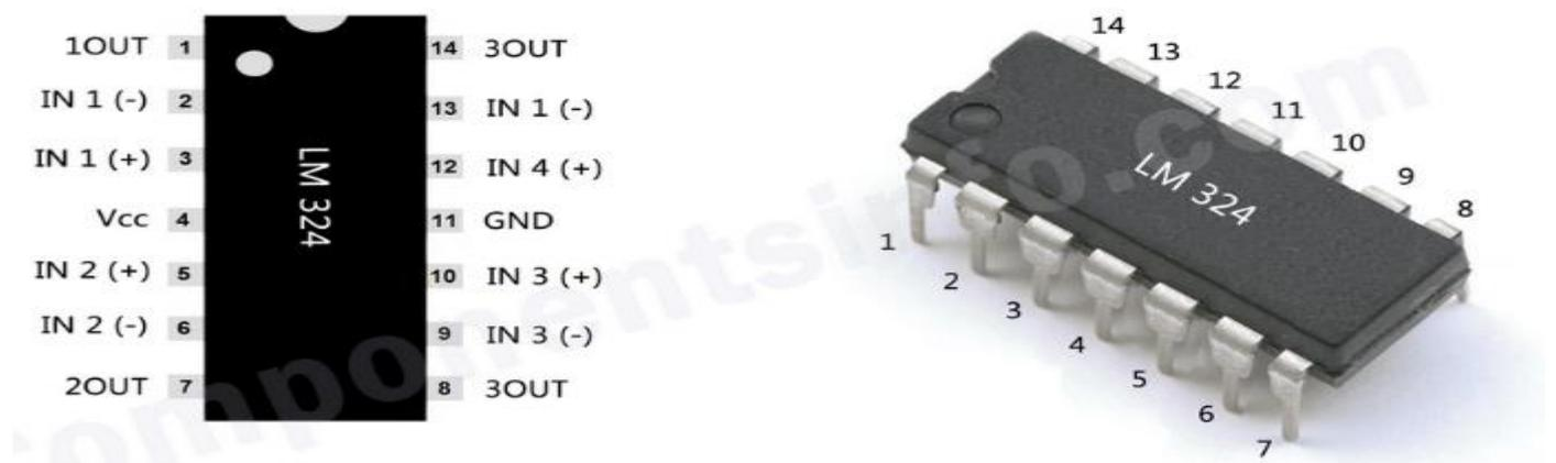
Figure 21 : Configuration des broches LM324
