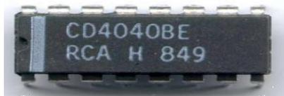
Fig.3. Circuit Intégré 4040
