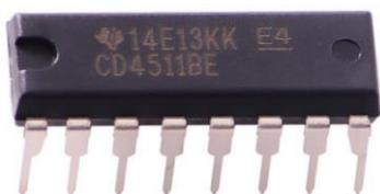
Fig.8. Circuit Intégré 4511
