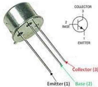
Fig.2. Brochage du Transistor 2N1711
