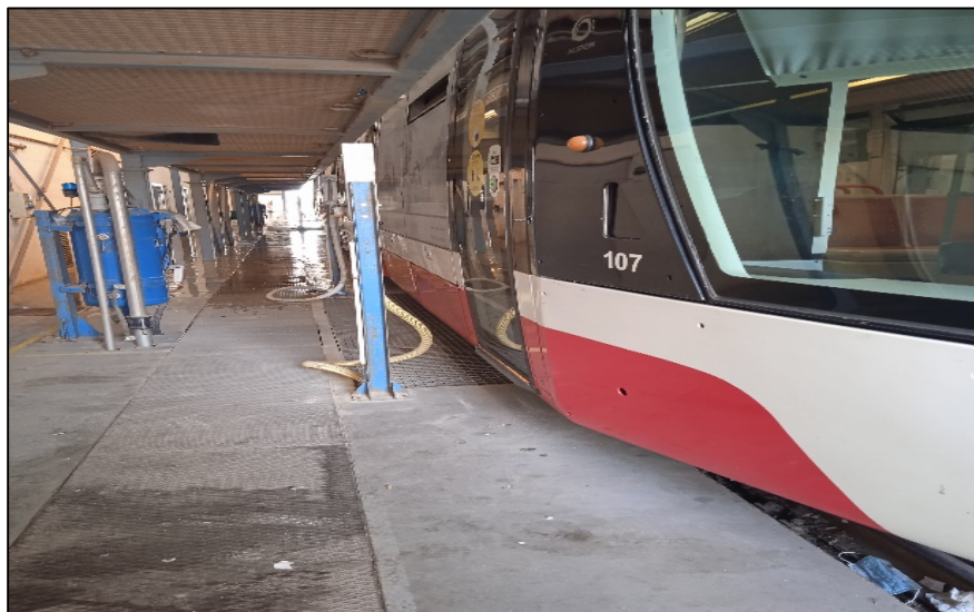
Figure I.8.1 - Poste de distribution de sable
