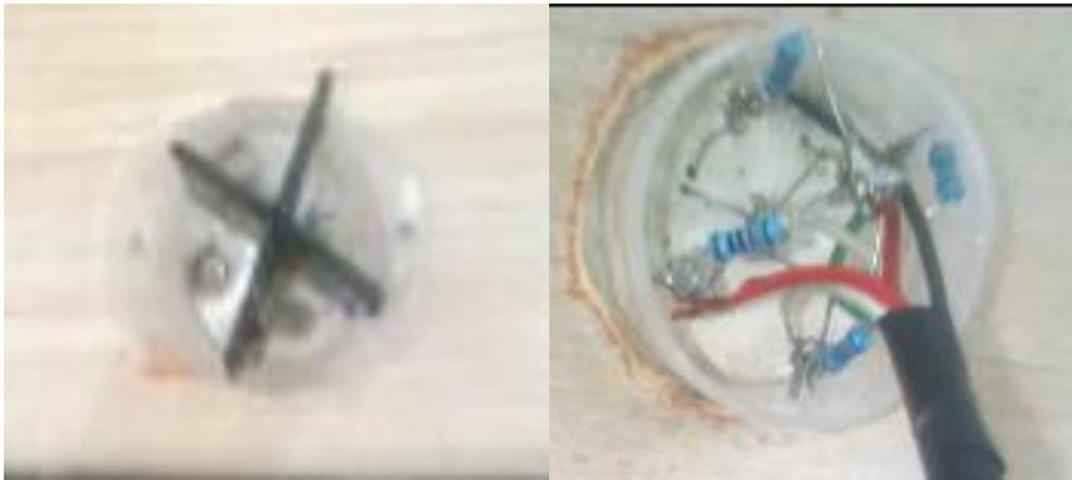
**La figure IV.4 :** *Vue de face et vue d'arrière de prototype des LDR final avec les résistances de 10k ohm.*
