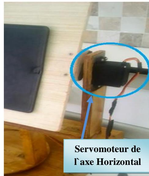
La figure IV.6 : l'installation des servomoteurs.
