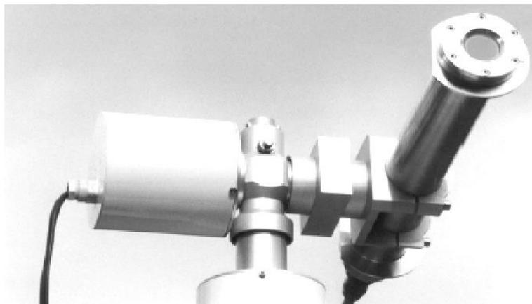
La figure I.5 : Appareil de mesure « un pyréliomètre ».
