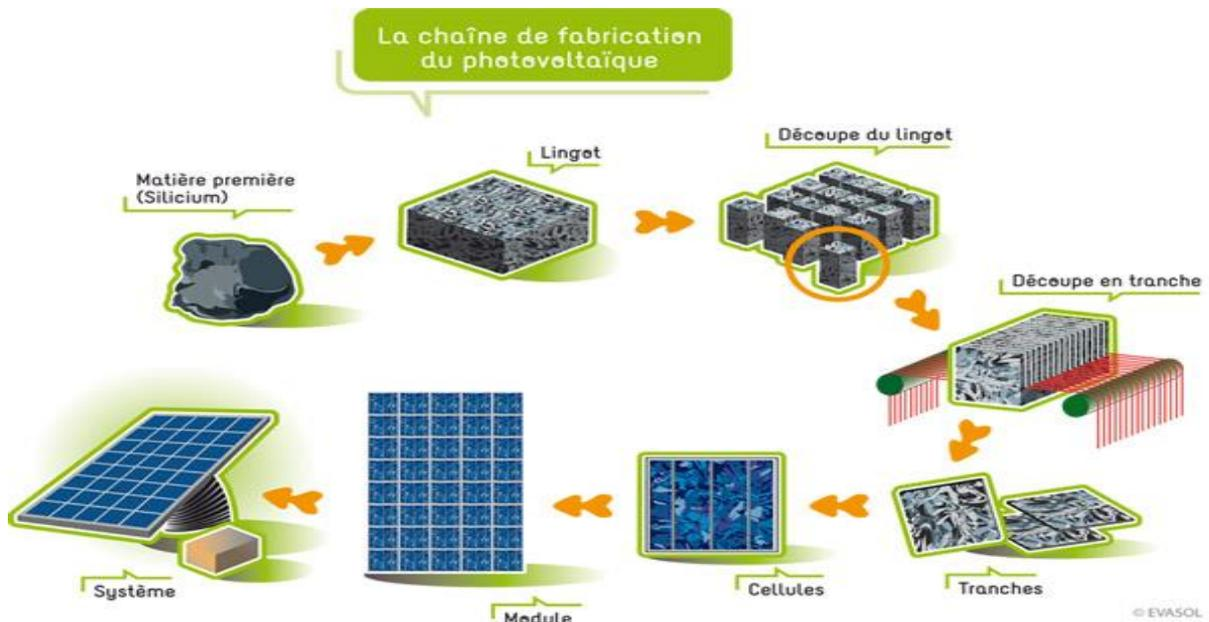
La figure I.12: La chaîne de fabrication des cellules photovoltaïques.
