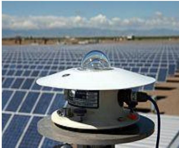
**Figure I.13:** Un pyranomètre.
