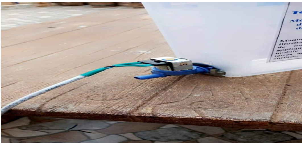
Figure 42: L'alimentation 220 v alternative de l'électrovanne
