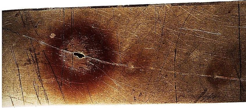
Figure 1-6 Corrosion par piqûres
