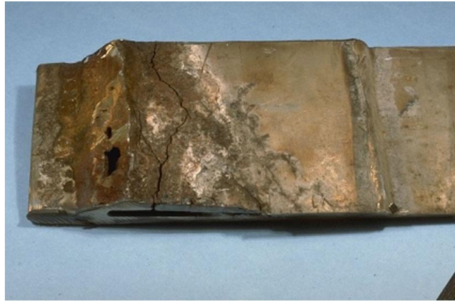
Figure 1-10 Corrosion sous contrainte mécanique
