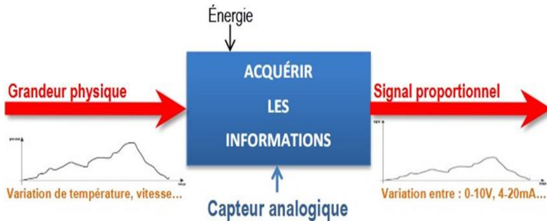
Figure 1.19 : Le principe capteur analogique
