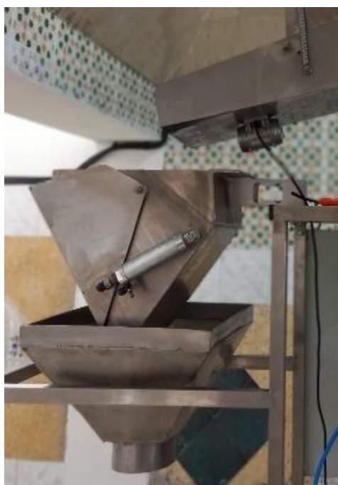
Figure 1.7 : Une trémie de pesage (goudi) équipée avec un vérin
