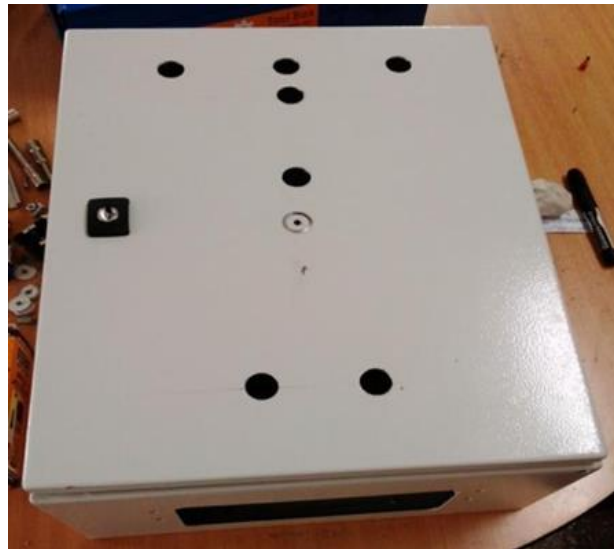
Figure 3.13: La face d'avant après le perçage
