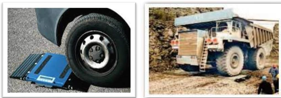
Figure 1.3 : Exemple d'une pèse par essieux
