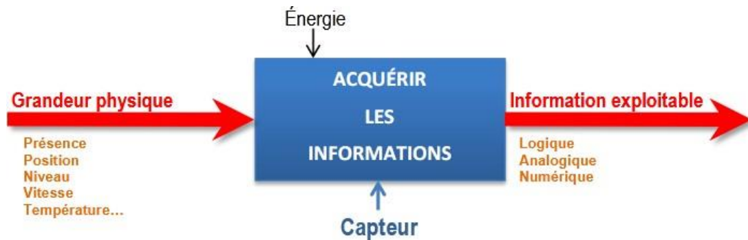
Figure 1.16 : la fonction d'usage d'un capteur.
