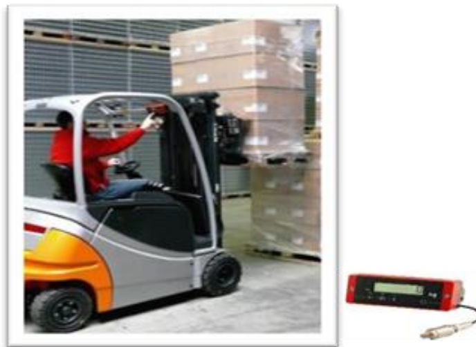
Figure 1.1 : Exemple d'un pesage hydraulique [1]
