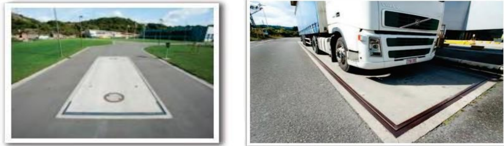
Figure 1.2 : Exemple d'une pèse par pont camion
