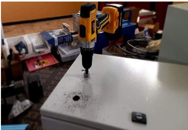
Figure 3.12 : Perçage la face avant.
