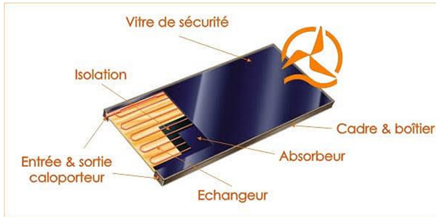
Figure 13 - Composants d'un capteur plan solaire vitré
