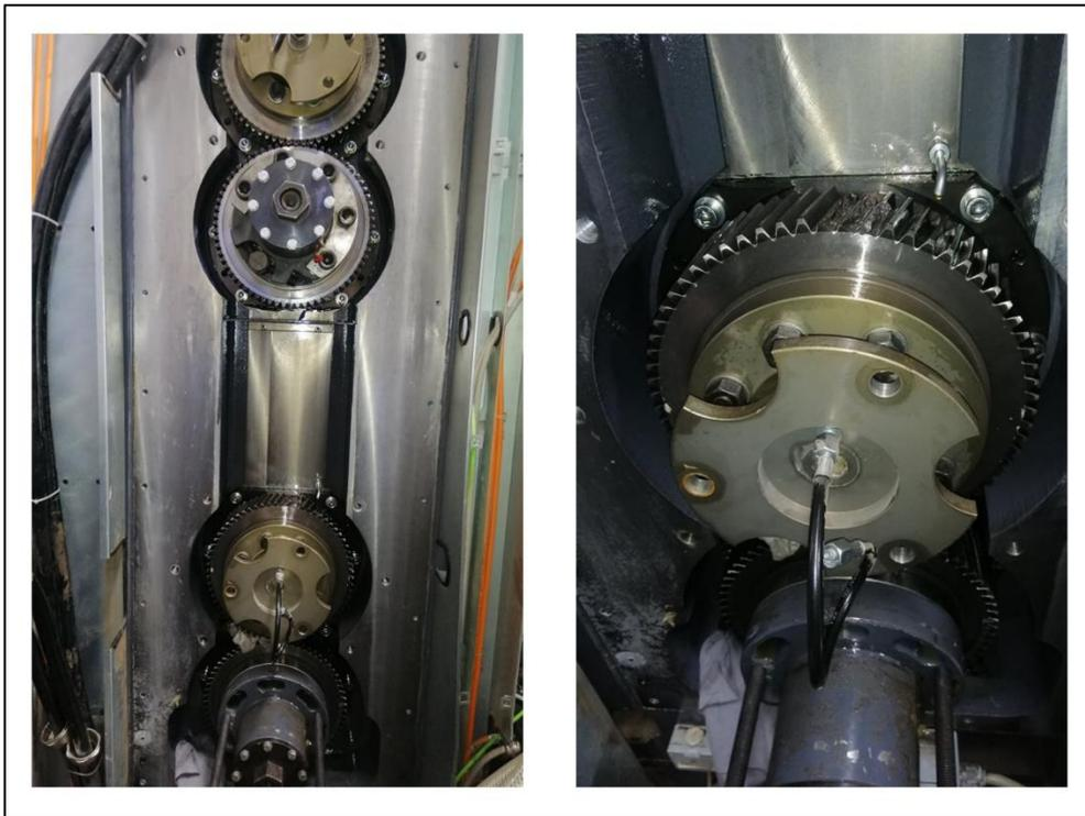
**Figure 3. 20** : Engrenages défectueux au niveau de la HQM.
