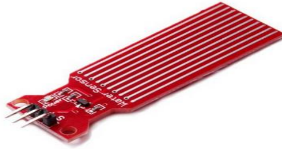
Figure II.11: Capteur de niveau d'eau
