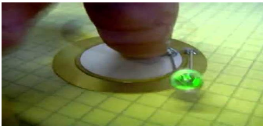
Figure (1-2).Générateurs piézoélectrique
