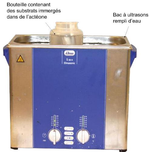
Figure III.8. Dégraissage des substrats dans un bain à ultrasons
