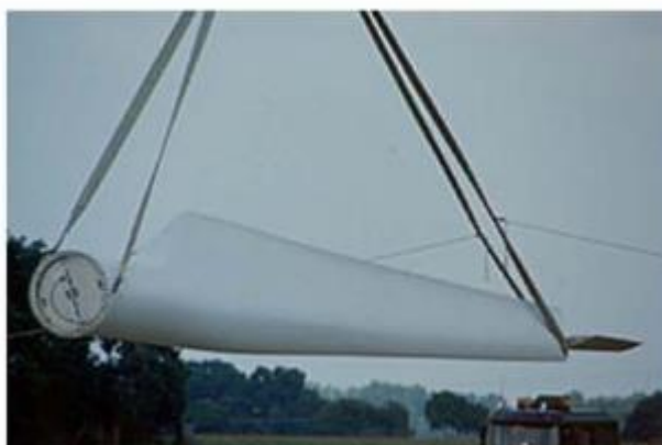
Figure 1.12 Pales d'une éolienne avec système de freinage en bout.
