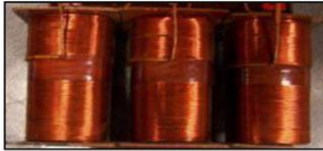
Figure I.13 : photo des enroulements d'un transformateur triphasé.
