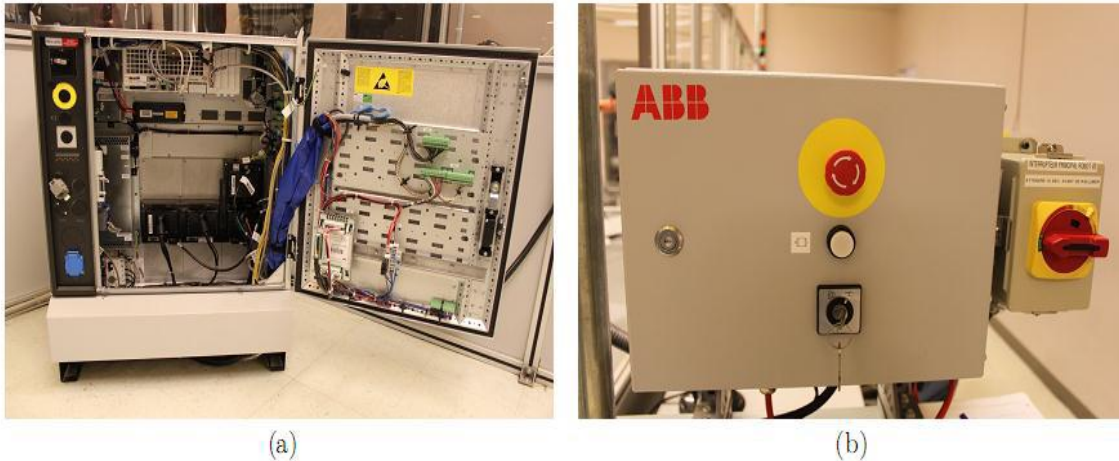
Figure (I.21) : (a) Contrôleur IRC5 standard de la compagnie ABB et (b) panneau opérateur externe d'un des quatre robots au laboratoire A-0610.
