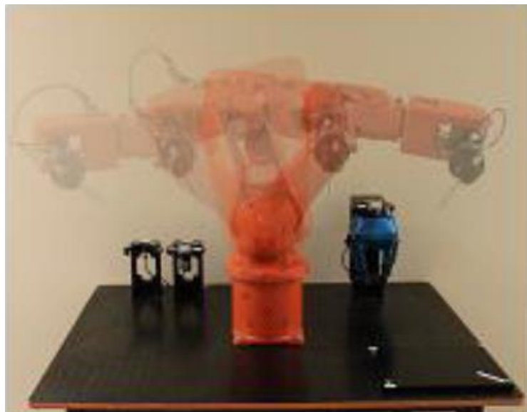
Figure (III.4) : Déplacement linéaire de l'outil (commande moveL).
