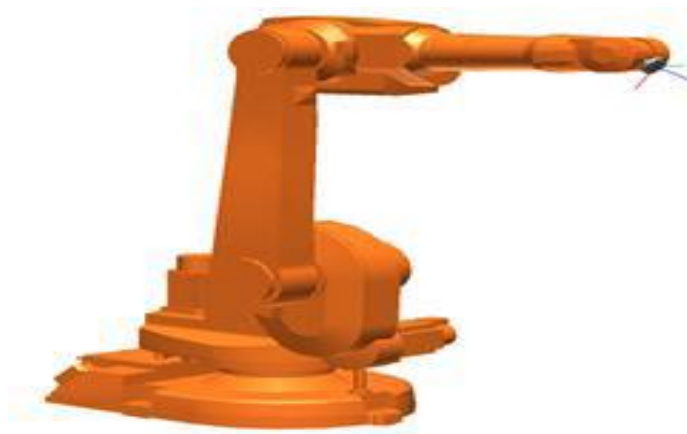
Figure (I.17) : Modèle 3D du robot IRB 1600.
