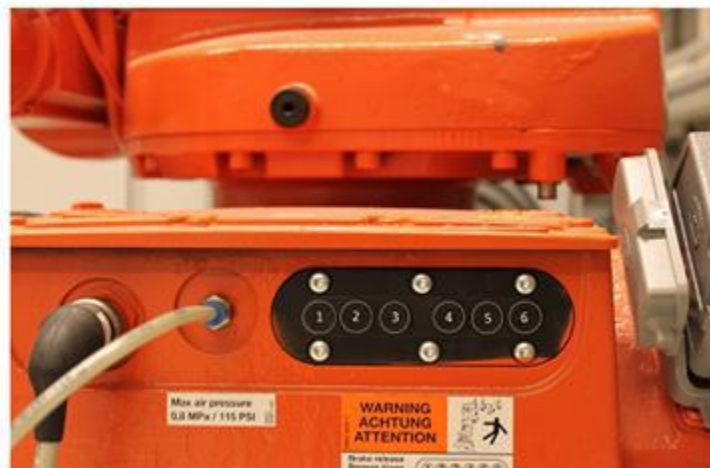
Figure (I.20) : Bouton pour relâcher les freins à ne jamais actionner.
