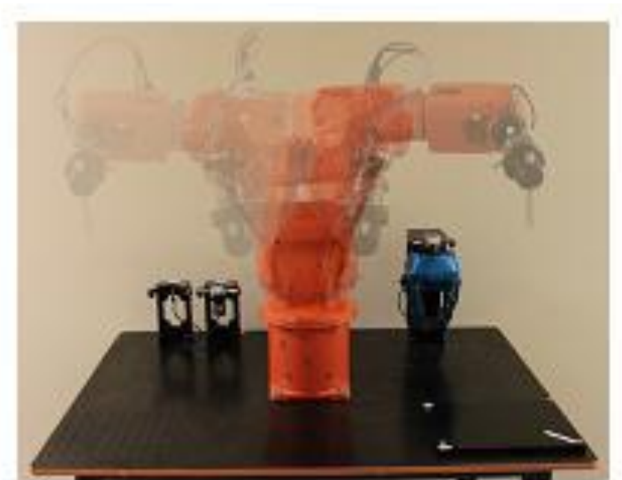
Figure (III.5) : Déplacement articulaire de l'outil (commande MoveJ).
