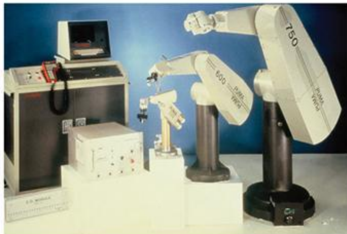
Figure (I.14) : Les trois premiers modèles du robot PUMA commercialisés par Unimation.
