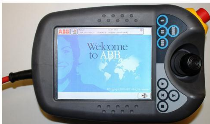
Figure (I.22) : Boîtier de commande FlexPendant de ABB.
