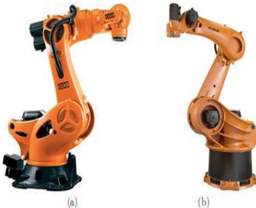
Figure (I.1) : Robots à six et cinq ddl : (a) robot sériel à six articulations et (b) robot sériel à cinq articulations.
