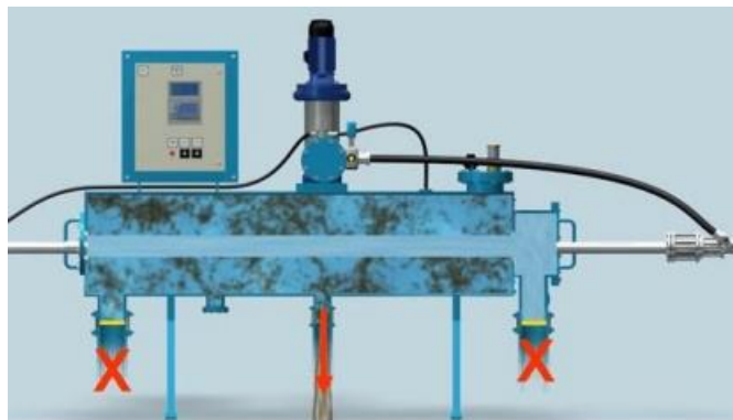
Figure 7 : la première étape de nettoyage
