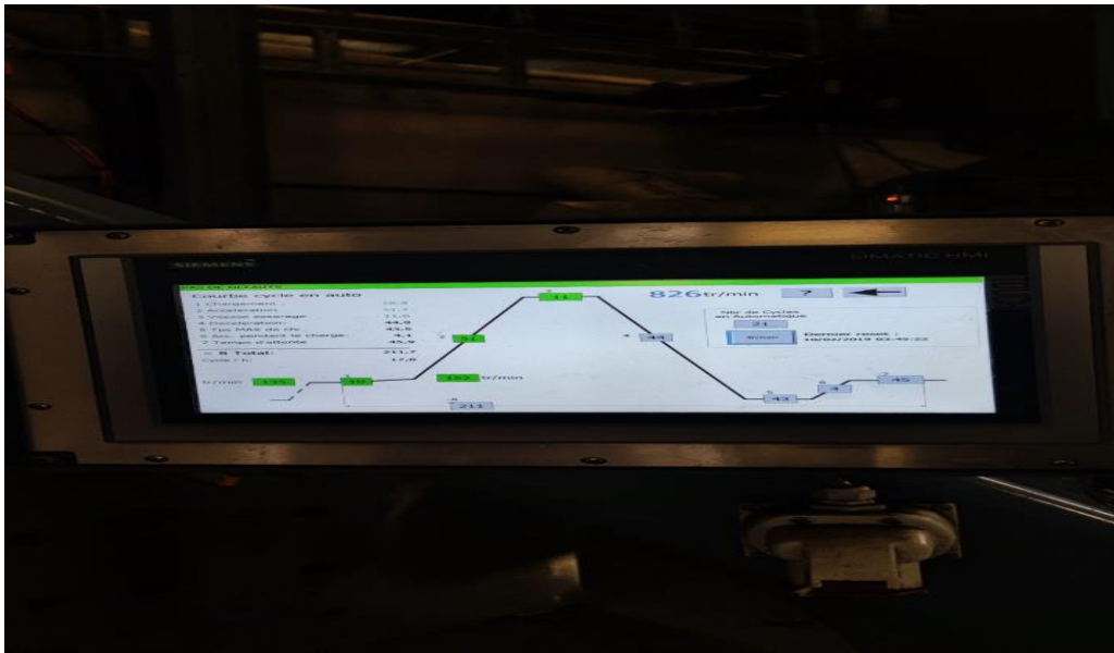
Figure 8: Cycle de fonctionnement d'une centrifuge discontinue
