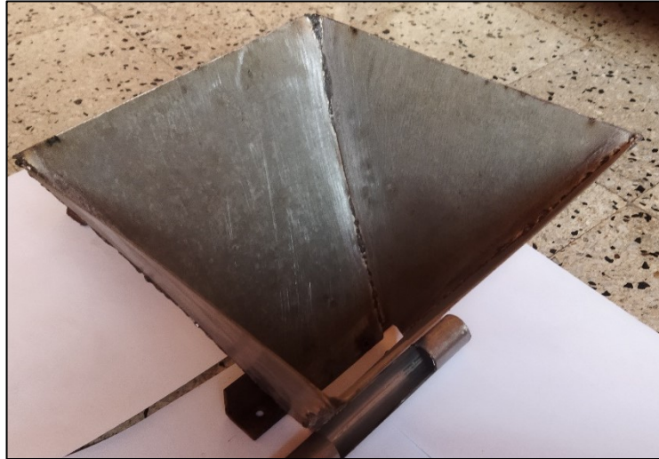
Figure 36. La trémie après la soudure.
