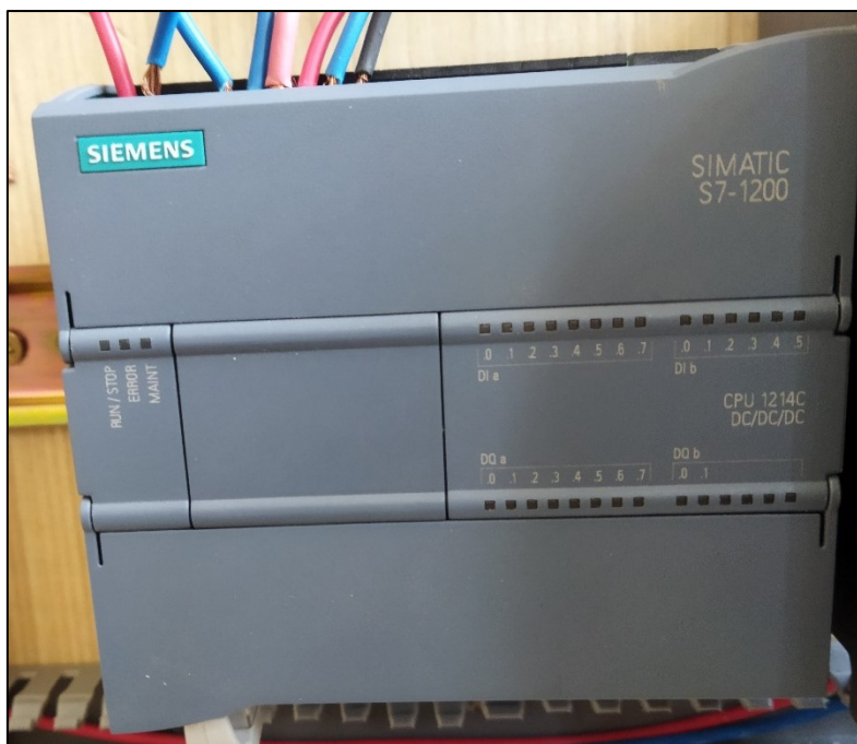
Figure 48. Automate Siemens S7-1200.
