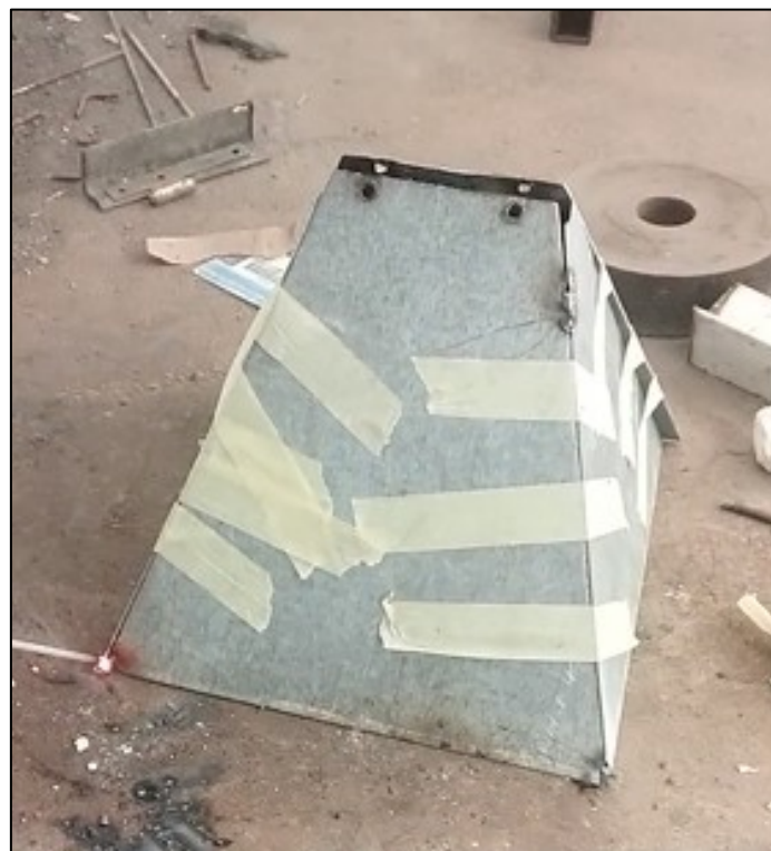
Figure 35. La soudure de trémie.
