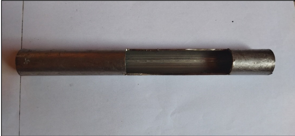
Figure 38. Le tube après avoir retiré une partie pour l'alimentation.
