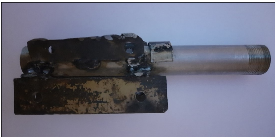
Figure 39. Le tube avec filetage et après la soudure avec des morceaux de fer.
