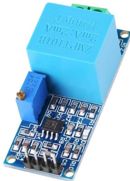
Figure II.5 : Le capteur de tension ZMPT101B
