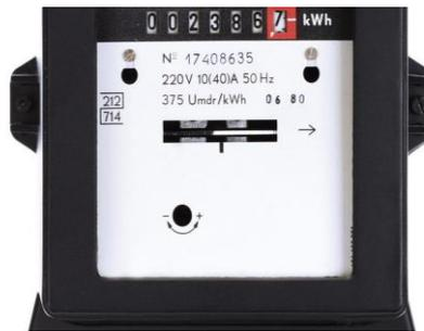
Figure I.1 : Compteur électromécanique
