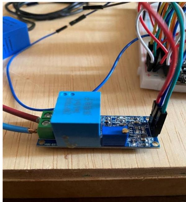
*Figure b : le capteur de tension zmnt-101B*
