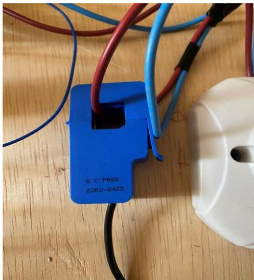
*Figure a : le capteur de courant SCT-013*
