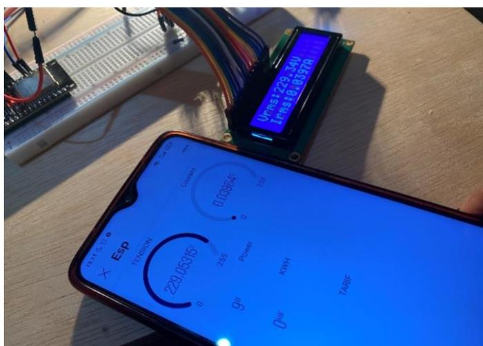
Figure III.9 : Affichage des données dans l'écran LCD et application blynk
