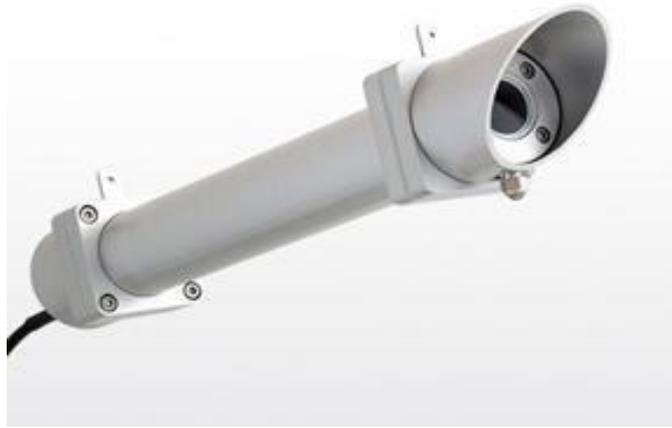
Figure 1. 7: Le Pyrhéliomètre
