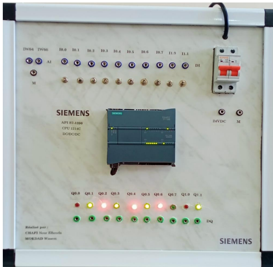
Figure IV.4 : Visualisation des sorties par les LEDs
