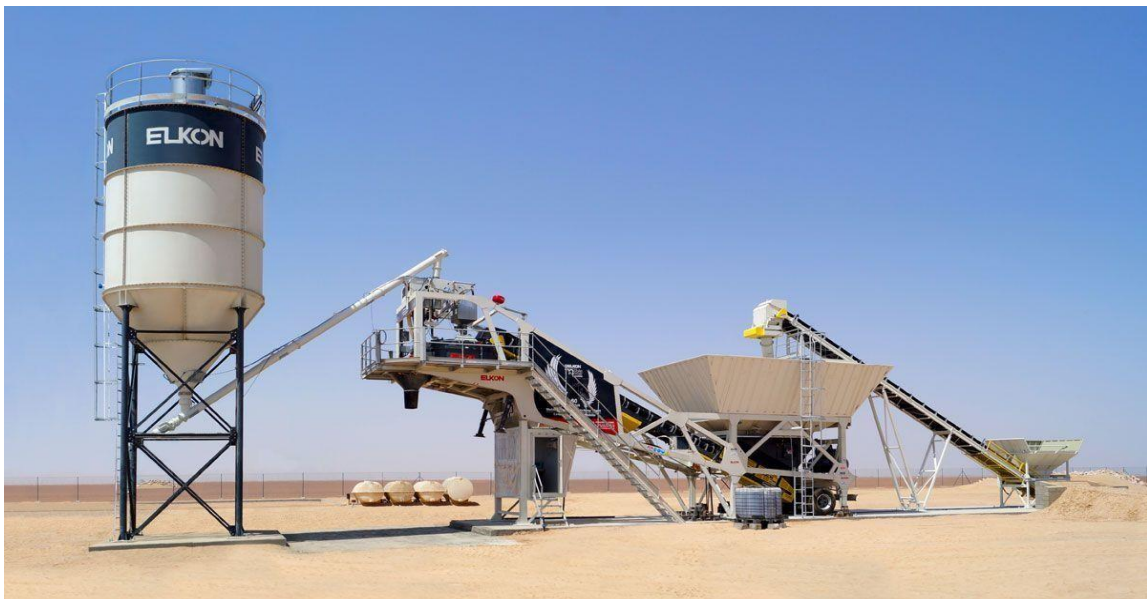
Figure 1 : Centrale à béton mobile.
