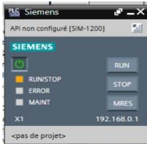
Figure 72 : Interface PLCSIM lancée.
