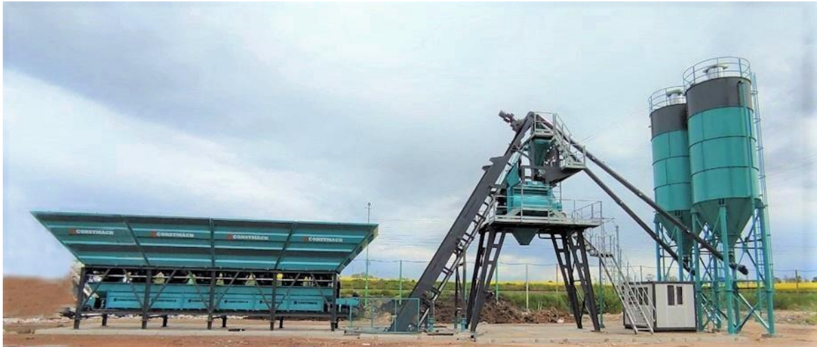
Figure 3 : Centrale à béton compacte.
