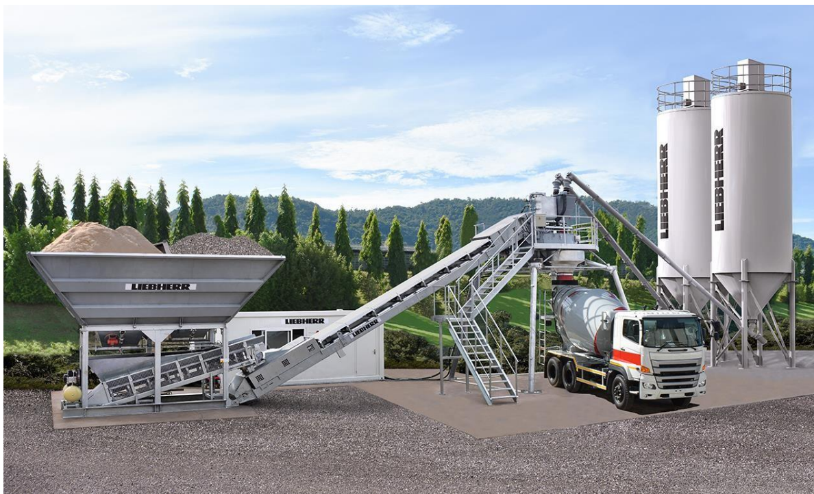
Figure 5 : Centrale à béton horizontale.
