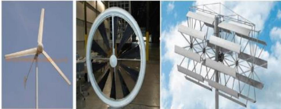
Figure 1.13 Eoliennes à axes horizontal.
