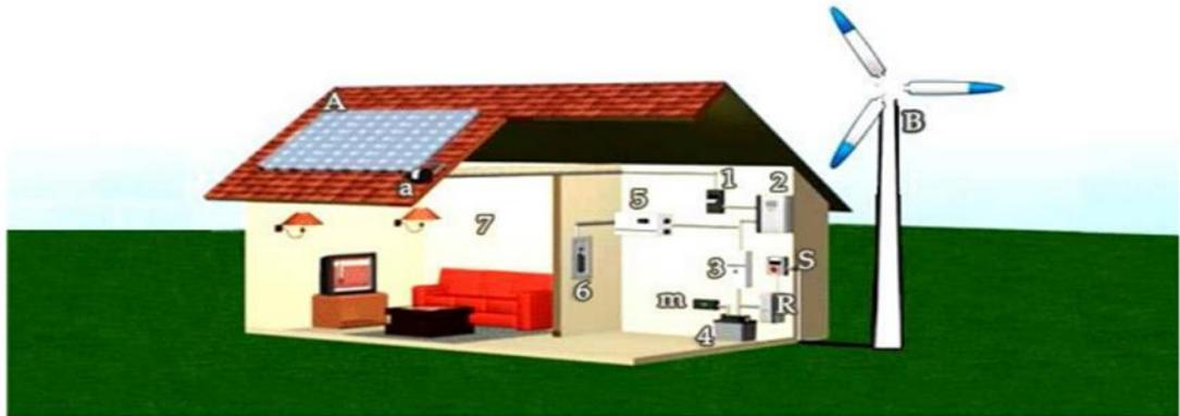
**Figure 1.17** *Système d'énergie hybride photovoltaïque-éolien*
