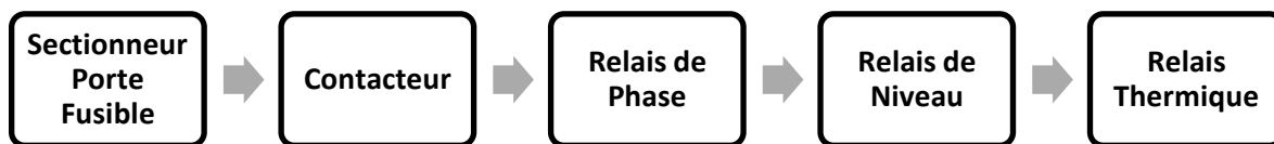
Figure. I. 14: Processus du diagnostic sur les appareillages électriques .
