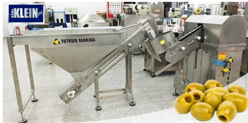
Figure I.10 : Machine d'élimination des noyaux
