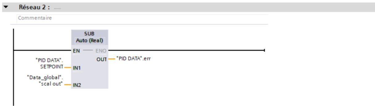
Figure III-26 :Réseau 02 du OB 30 qui représente la valeur d’Erreur de la boucle
