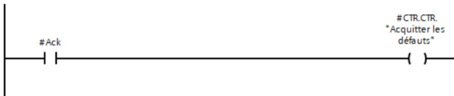
Figure III-32 : Réseau 03 Pour acquitter les defaults au variateur
