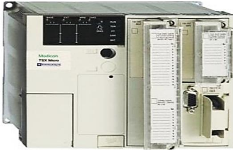
Figure 1.4 La Partie Commande (automate programmable)
