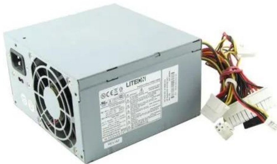
Figure 25- Boite d'alimentation d'un ordinateur de bureau
