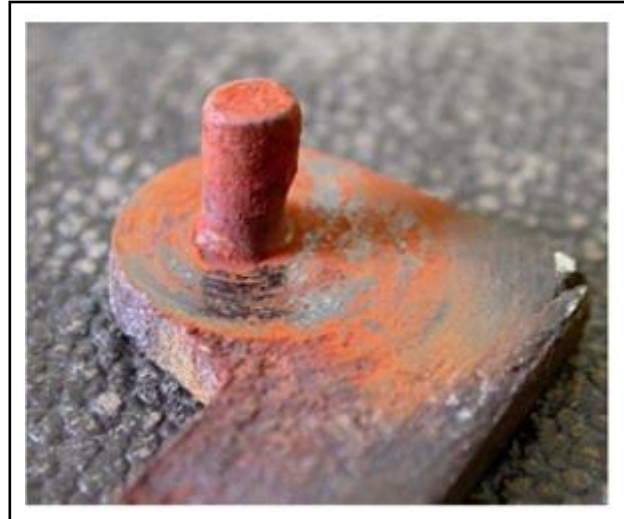
Figure 4.6 : Manifestation de l'usure corrosive
