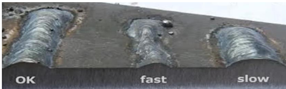
Figure 2 .11 Effet de la vitesse de soudage
