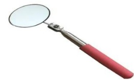
Le miroir d'inspection
