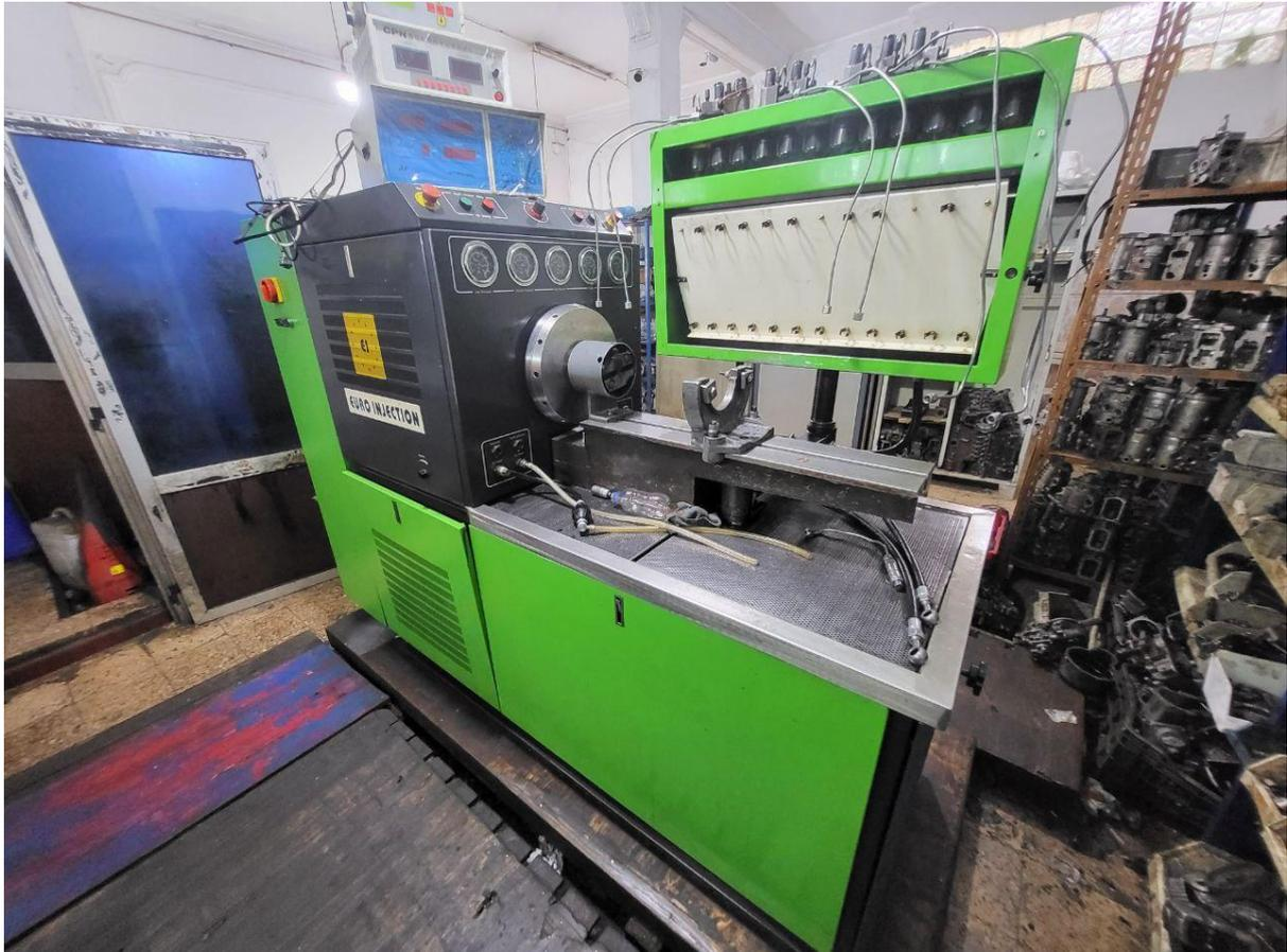
**Figure II.5:** Banc d'essai de pompe injection de carburant diesel.
