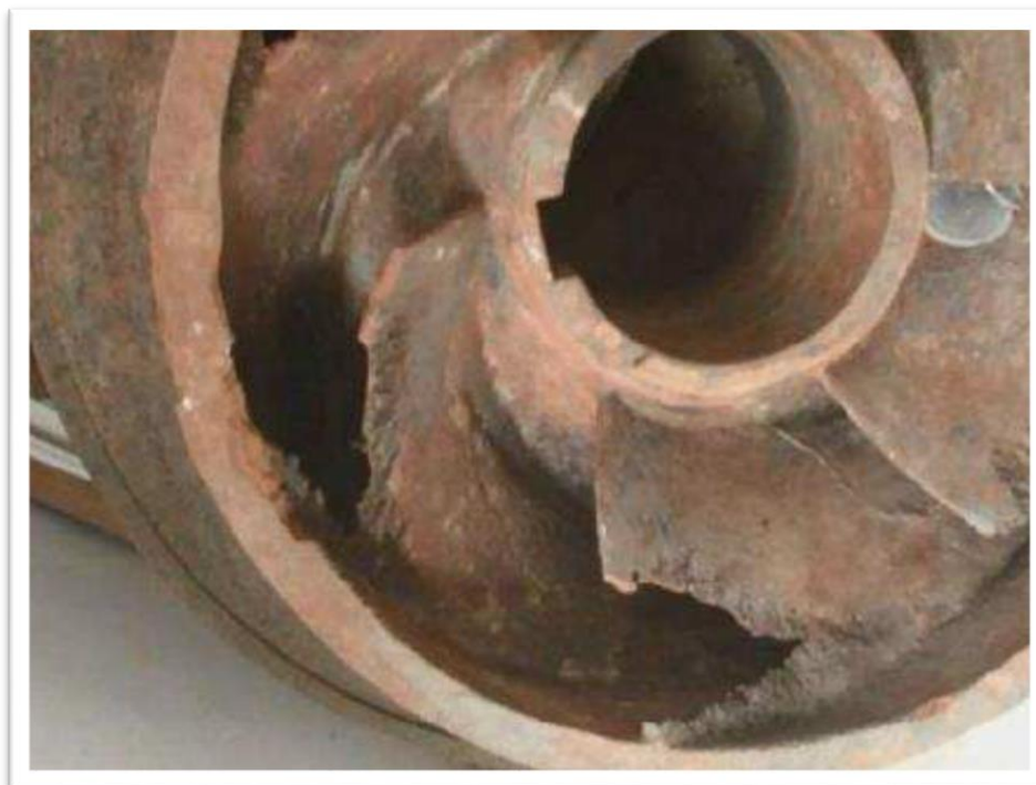
Figure I-30 : les dégâts subis par une pompe
