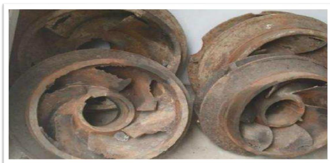
Figure I-29 : Roues des pompes centrifuges cavités
