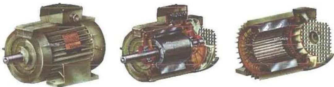
FIGURE 1.12 structure de moteur asynchrone 3ph
