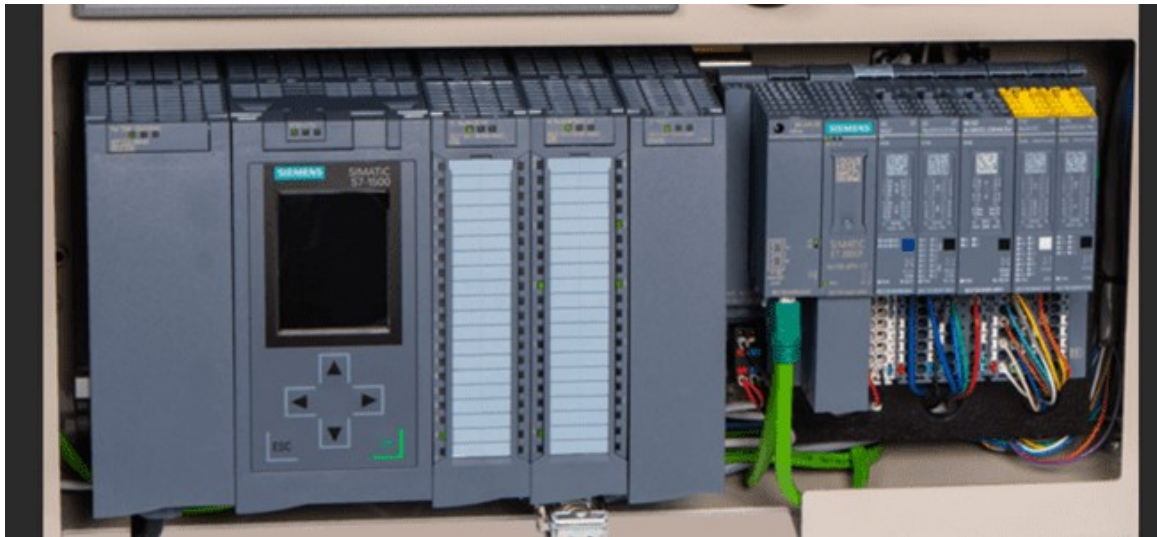
FIGURES I.19 L'Automate S7-1500 (unité centrale) - Siemens
