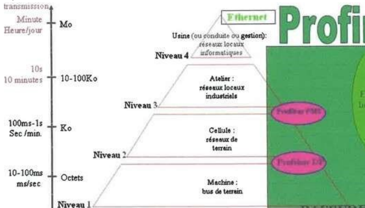
FIGURE II .2 pyramides des réseaux profinet Profibus CIM
