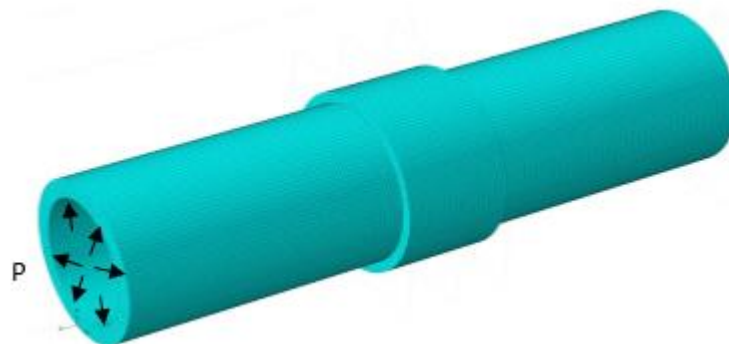
Figure 67 : Pipeline réparé soumis à une pression
