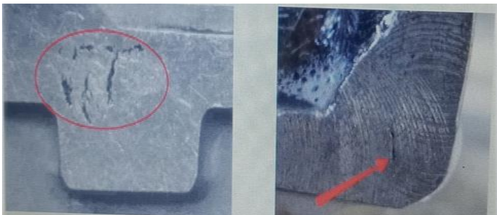
Figure 10 : défauts de soudure
