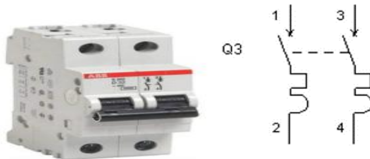
Figure II.16 Symbolisation d'un disjoncteur bipolaire
