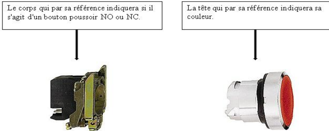
Figure II.18 Composition d'un bouton passeoire
