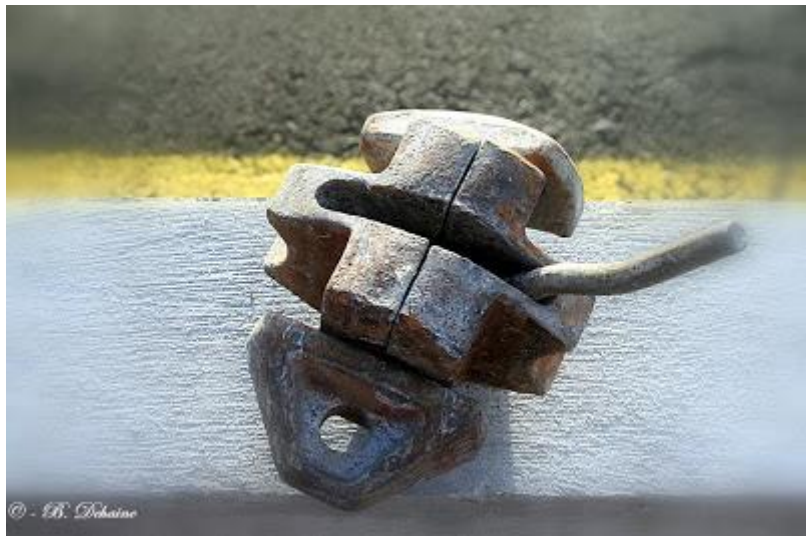
Twistlock (verrou tournant) en position bloqué ou fermé.
