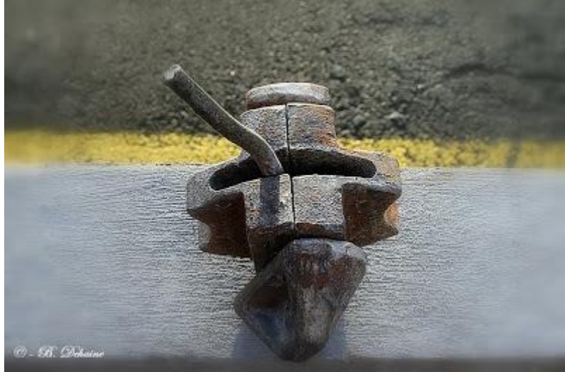
Twistlock (verrou tournant) en position ouvert.
