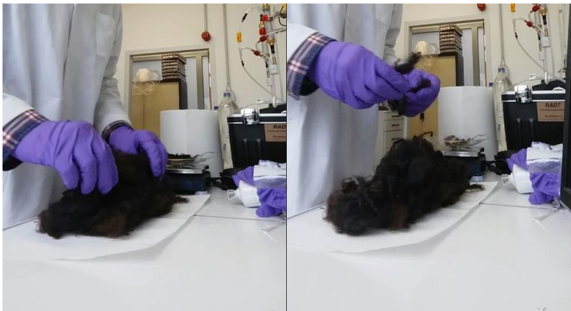
Fig. 51. Opération d'effilochage de la Fibre-Mn au laboratoire LHA (Photo prise par Zemour Y.)
