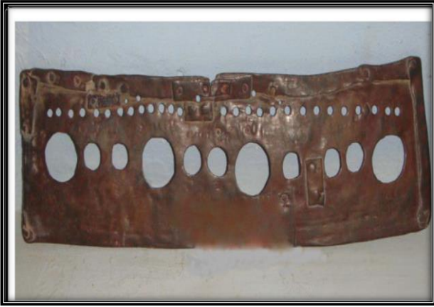
صورة رقم (2) آلة كيل الماء في الفقارة
