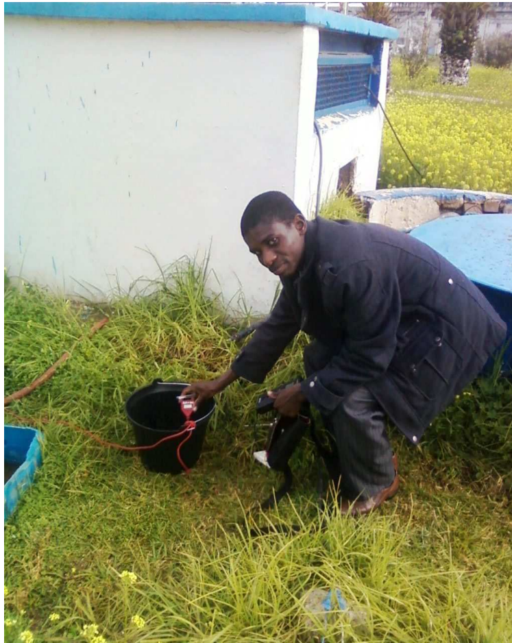
Photo 2 : Mesure piézométrique dans un forage au sein d'une unité industrielle.
