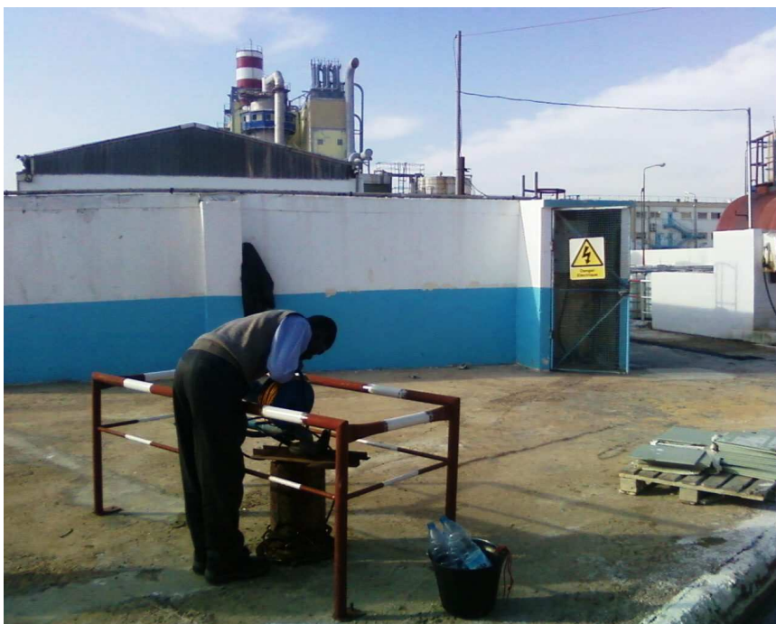
Photo 2 : Mesure piézométrique dans un forage au sein d'une unité industrielle.
