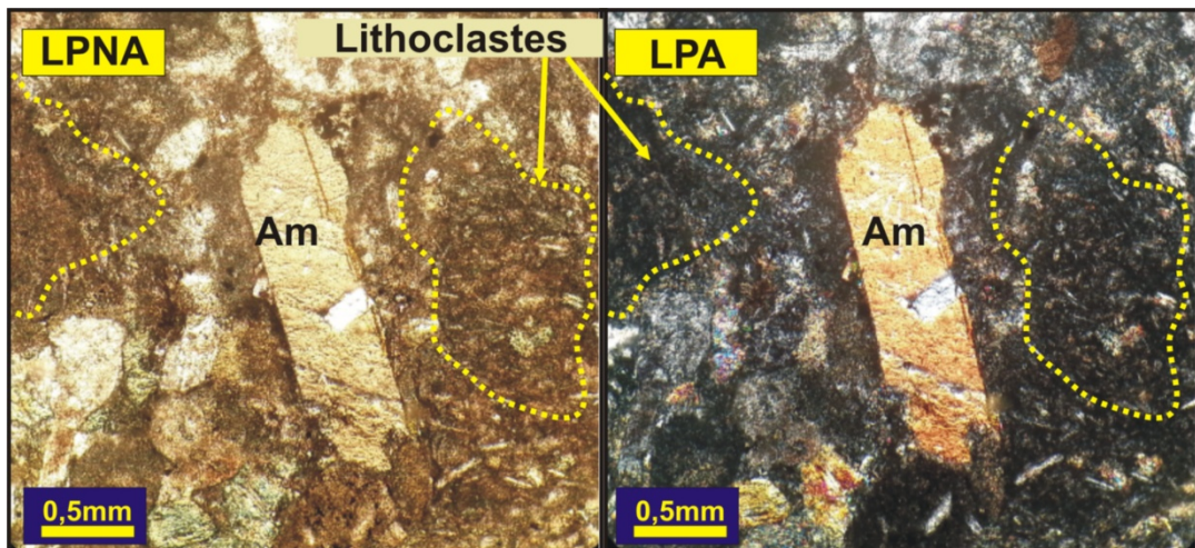
Fig. 36 Microphotographie d'un cristaloclaste d'amphibole dans le tuf andésitique de Sebka En Nhass (G.X10).
